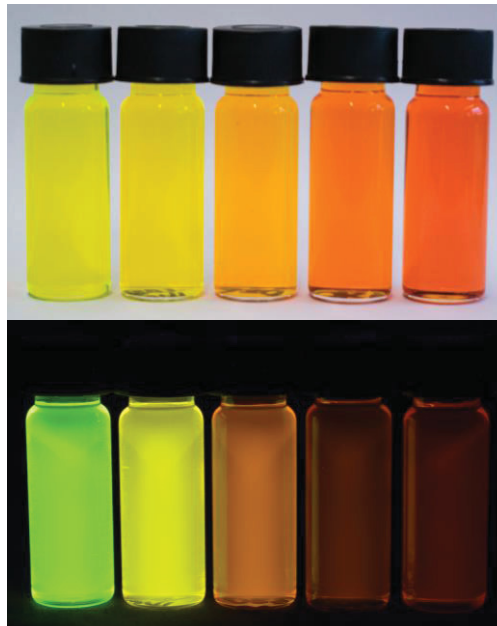
Abbildung 30: Augenscheinliche Wahrnehmung der Absorptions- (oben) und Emissionseigenschaften (unten, \lambda_{exc} = 365 \text{ nm} ) des 3-Cyano- \alpha -pyrone 10c mit zunehmender Lösungsmittelpolarität von links nach rechts (Toluol, Ethylacetat, Aceton, DMF und DMSO, c(\mathbf{10c}) = 10^{-4} \text{ M} ).
